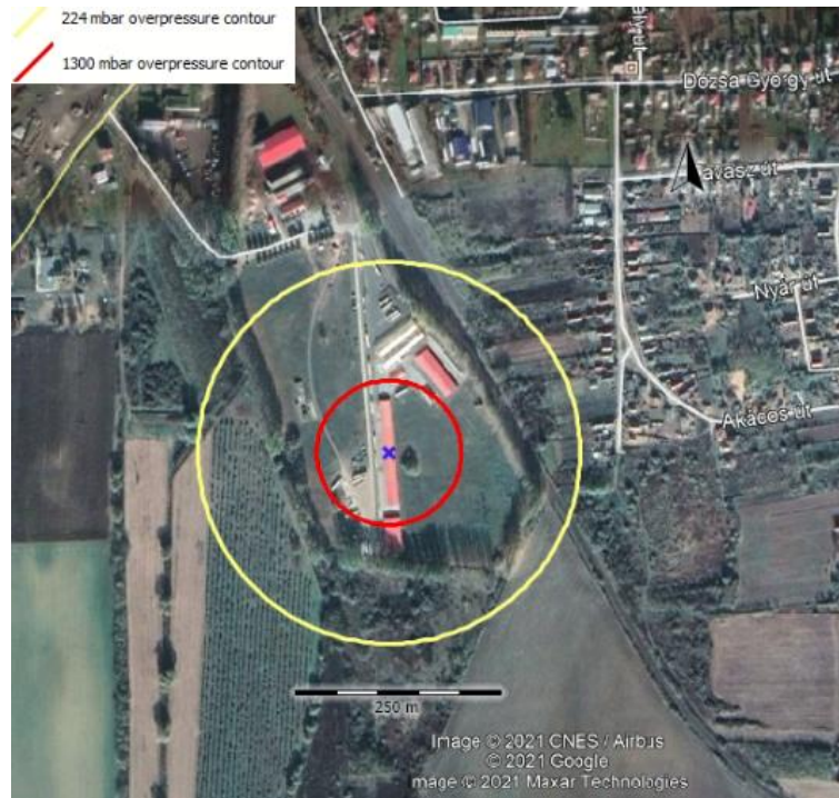
13. ábra: 200 tonnás AN rakat robbanása során kialakuló túlnyomás határok (III-as raktárra bemutatva)
