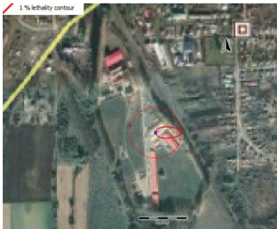
16. ábra: NV Raktártűz során felszabaduló HCl terjedése során kialakuló 1%-os halálozási kontúr (F3 légállapot)
